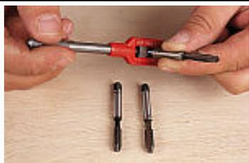
●2. PLACER le taraud ébaucheur (le plus conique) dans le tourne-à-gauche et le serrer fortement.
