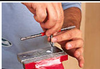
●5. En dévissant totalement le taraud ébaucheur, la limaille sera éliminée. Dévisser sans hâte, bien dans l'axe, en veillant à la sortie du taraud.
