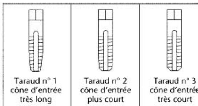
Ces derniers permettent de creuser un sillon hélicoïdal (filet) à l'intérieur d'un alésage calibré où vient se loger un élément fileté par exemple une vis:
