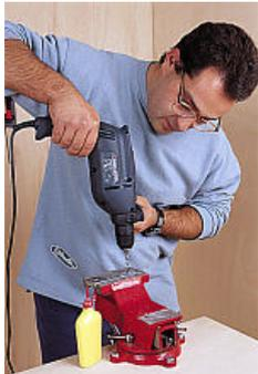
●1. PERCER le trou au diamètre correspondant aux tarauds.
