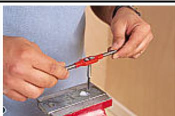
●6. Changer *l'ébaucheur pour le taraud intermédiaire* et recommencer l'opération avec les mêmes précautions. Ne pas forcer le taraud dans l'empreinte précédente.
