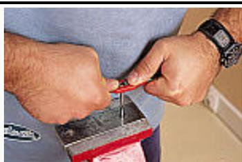
●3. Parfaitement perpendiculaire au perçage, commencer à VISSER lentement tout en maintenant fermement la position.
