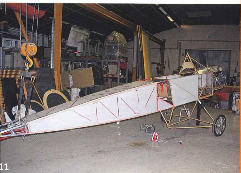
**12.** Pour coller la toile sur la structure métallique, il existe deux solutions : un enduit aéronautique homologué ou une simple colle Néoprène liquide, l'option retenue par nos lecteurs.
