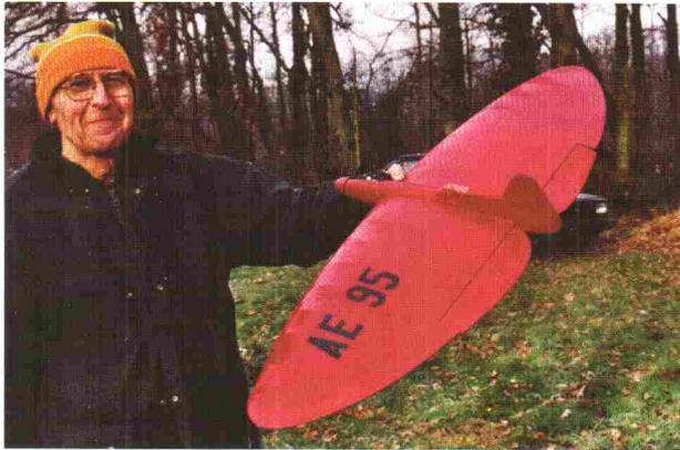
Aile volante elliptique à profil dégressif. Conçu en 1995, ce modèle est motorisé par un Webra 3.5 cm<sup>3</sup> et se pilote tout en douceur.
