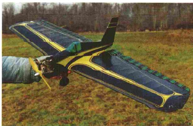
Aile volante construite sur la base d'une aile de Nobler. L'excellent Micron 29 est monté tête verticale.
