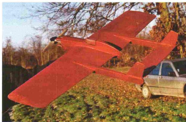
Un super voltigeur par excellence : le Bi-queues motorisé avec un Super Tigre G20/23. Le volet de profondeur qui est largement soufflé par l'hélice, rend ce modèle très maniable.
