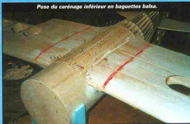
Première étape de la fabrication du capot moteur.
