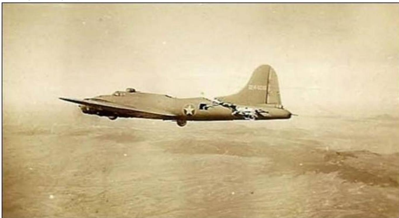
Bien que la queue cabossée se balançait dans le vent relatif, elle se tordait lorsque l'avion tournait et tous les câbles furent sectionnés à l'exception d'un seul pour la profondeur qui fonctionnait encore, et l'avion continuait miraculeusement à voler !
