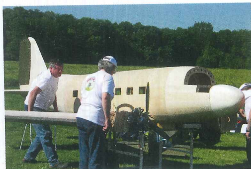
Cet énorme Dakota de 8,38 m d'envergure est l'œuvre de la Zoulou team, une bande d'amis avec comme chef de file Eric Kiatkowski. Les caractéristiques sont impressionnantes avec deux moteurs Moki 5 cylindres en étoile de 400 cm3 et une masse estimée à 130 kg. Non terminé, le modèle est entièrement en bois recouvert de tissu de verre.
