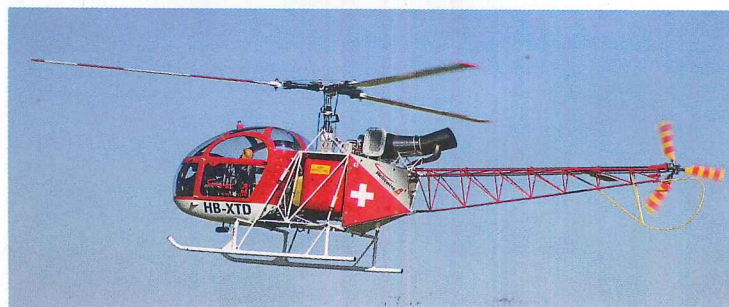
Le Lama de Richard Rivault. Cet hélicoptère issu d'un kit Vario est motorisé par une turbine Jakadofsky. Le diamètre rotor est de 2,50 m pour une masse de 19,5 kg. Une machine absolument magnifique.
