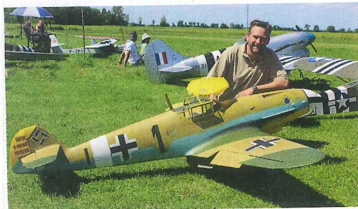
Un avion particulièrement à l'aise sur l'herbe verte de Normandie, le Messerschmitt 109 G2 de Arnim Morgenweck. Une réalisation superbe de 2,56 m d'envergure pour 18 kg. L'avion est motorisé par un 100 cm 3 .
