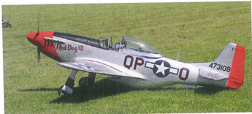
Le P51 de John Barnitz volait au sein du team allemand. La maquette est superbe, issue d'un kit Carf Models. Elle est motorisée par un DA 85 cm3 et affiche une envergure de 2,60 m.
