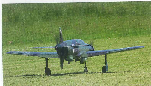
Au décollage le Dornier 335 de Roland Sabatschus. Un avion puissamment motorisé avec deux Titan 45 cm3. L'envergure est de 2,50 m et la masse de 21 kg.
