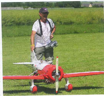
Le P51 de John Barnitz volait au sein du team allemand. La maquette est superbe, issue d'un kit Carf Models. Elle est motorisée par un DA 85 cm3 et affiche une envergure de 2,60 m.
