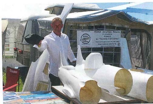
Alain Ronk a créé sa société Ronk Aviation Résine. Il propose plusieurs kits composés de fuselages en fibre de verre (réalisés en France) et de plans pour fabriquer soi-même la voilure et l'empennage.
